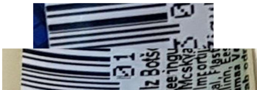
Figura 15 - Cod de bare imprimat defectuos, cu o dungă albă suplimentară care împiedică citirea lui
